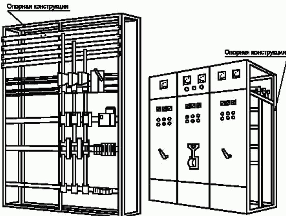
Рисунок С.1 — НКУ заводского изготовления открытого типа
