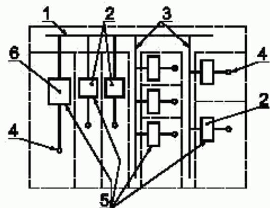
1 — сборные шины; 2 — блок вывода; 3 — распределительные шины; 4 — зажимы для внешних проводников; 5 — функциональные блоки; 6 — блок входа
