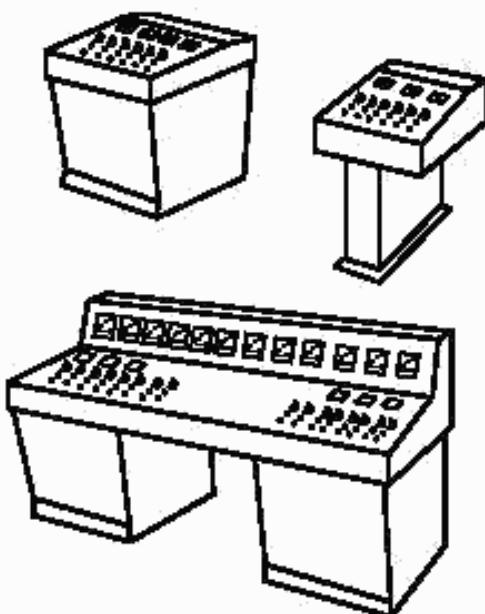
Рисунок С.5 — НКУ заводского изготовления пультового типа
