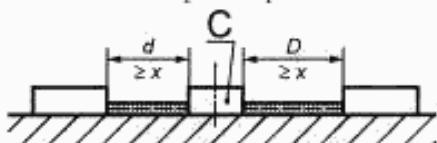
$C$  — свободно движущаяся часть; воздушный зазор равен  $d + D$ ; расстояние утечки равно  $d + D$ .
